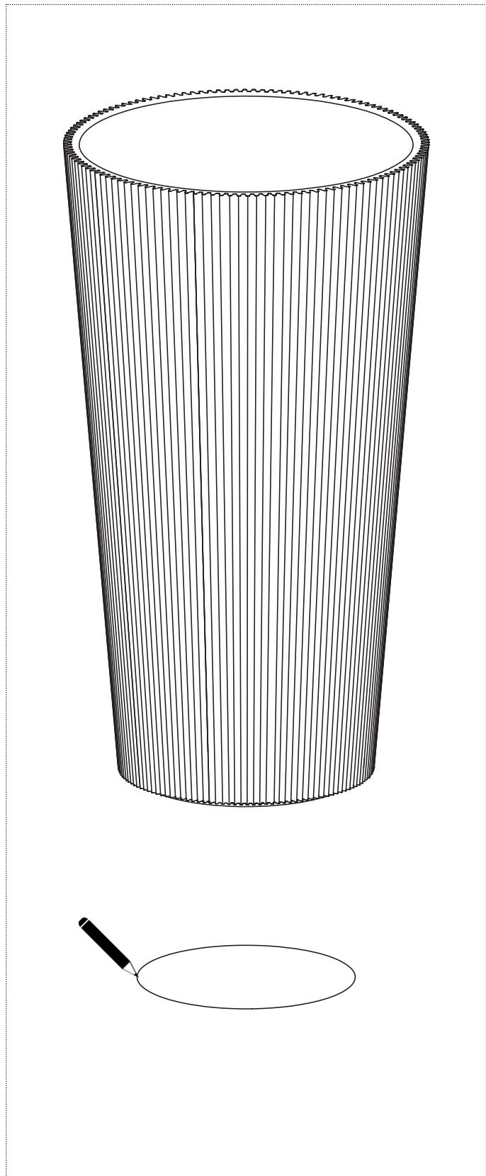
**IT\_2** Posizionare il lavabo quindi tramite una matita tracciare il profilo di base del lavello al suolo.
