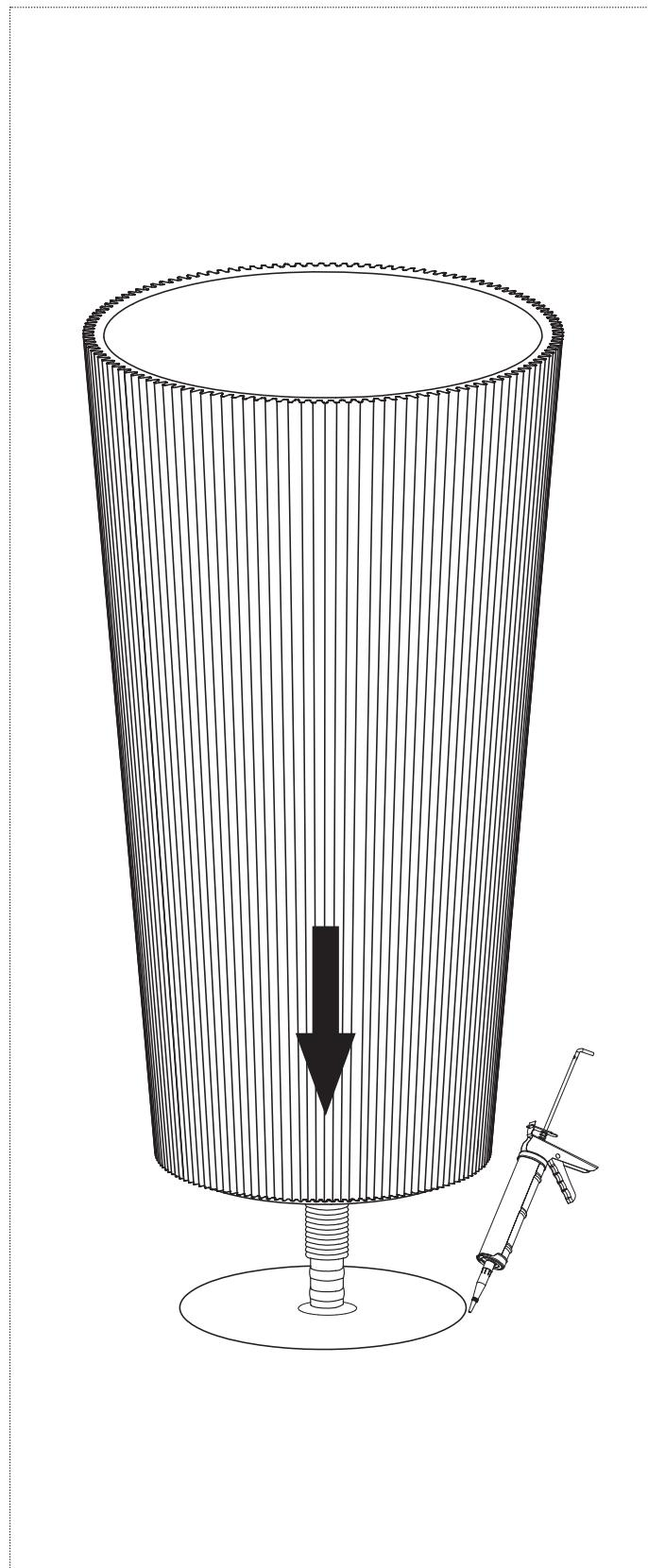
**IT\_3** Sollevare l'articolo e fissare il tutto con silicone o collante a seconda del tipo di pavimento.
